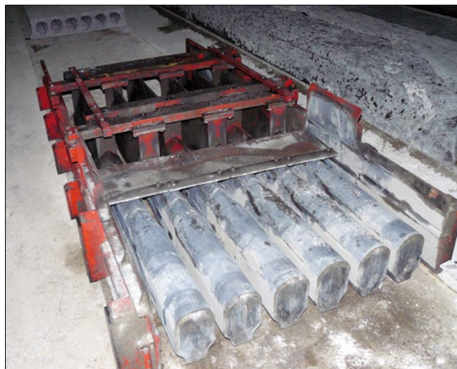
Рис. 6. Трубоопалубочный комплекс в машинах-слипформерах Fig 6. Pipe-shuttering complex in machine-slipformers
