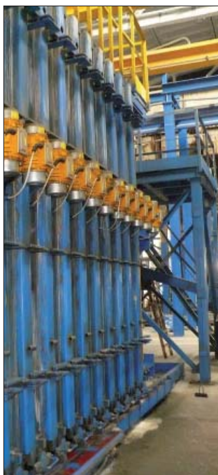
Рис. 5. Современное кассетное производство
