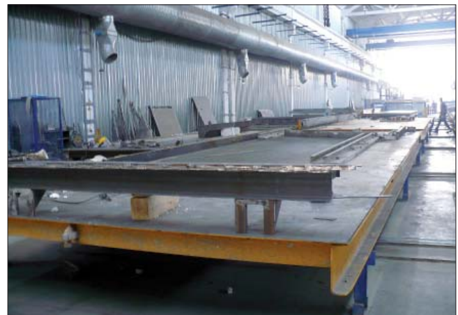
Рис. 2. Паллеты с переставными бортами длиной 9 м
